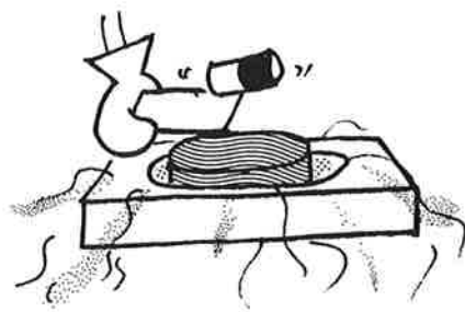
磁石と超伝導体の間に紙片を通す
