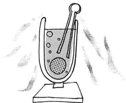
液体窒素に浸して、塩ビピンセットでぐるぐる回して全体を冷却させる (約30秒)
